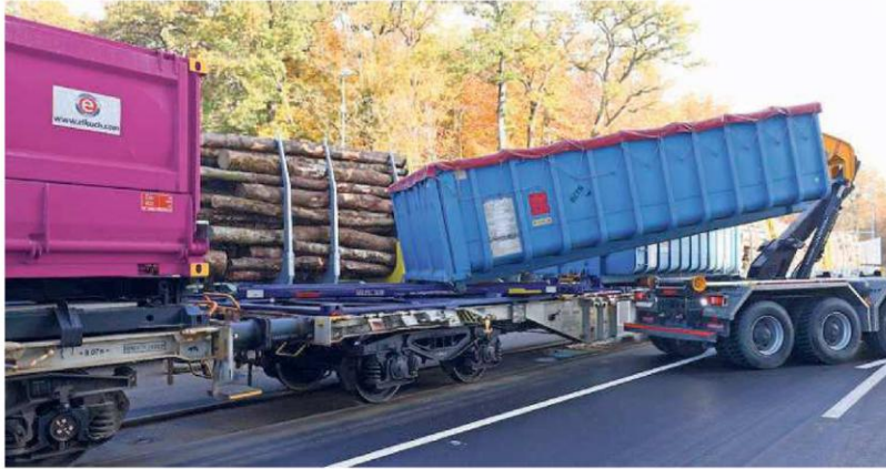
La nouvelle place de transbordement permet désormais de manutentionner des conteneurs qui passent de la remorque du camion au wagon en un rien de temps. On espère ainsi élargir l'éventail des marchandises transbordées. PHOTO ROBERT SEIGENTHALER
